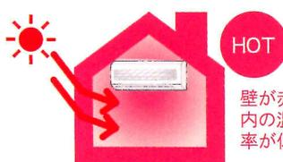
壁が赤外線を吸収してしまうと室内の温度が上昇し、エアコン効率が低下してしまいます。
