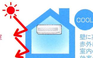
壁に高日射反射率塗料を施工すると、赤外線をより多く反射します。そのため、室内の温度が上がりにくくなり、エアコン効率がアップし省エネに繋がります。
